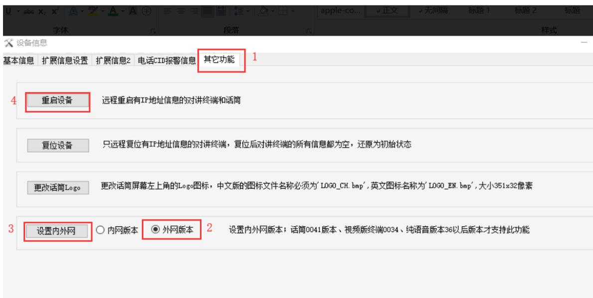
2、打开 Windows 资源管理器，在地址栏输入 <ftp://话筒 IP>，确定后进入主机资源件目录，将 IP 网络扫描配置工具目录下的“NatServer.txt”文件拷贝至话筒“CardA”目录即可。
